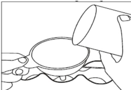
4.3. Используя зажигалку (H), поставляемую в комплекте с биокамином, зажгите топливо в резервуаре, поднеся пламя к поверхности топлива.
