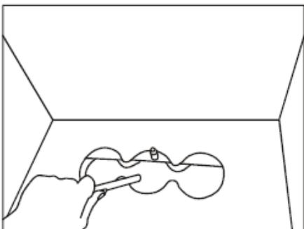
4.4. Через некоторое время отрегулируйте размер пламени, перемещая заслонку резервуара с помощью прилагаемого манипулятора (G).
