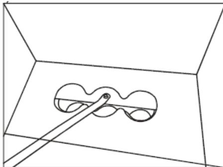
4.5. Размер пламени регулируется в диапазоне от положения максимального открытия заслонки до положения максимального прикрытия, показанного на рисунке ниже. Диапазон открытия заслонки установлен в соответствии с режимом оптимального горения, поэтому не рекомендуется превышать границы данного диапазона, за исключением тех случаев, когда требуется полностью погасить пламя. Для того, чтобы погасить пламя, необходимо перевести заслонку в положение «закрыто».
